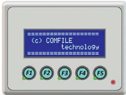
다음과 같이 UIF-5K 와 MSB 시리즈를 연결하여 주십시오. UIF-5K 에는 9V~24VDC 전원을 별도로 연결해야 합니다.
